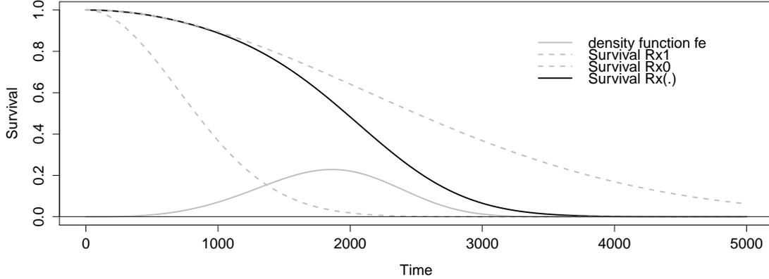
FIGURE 2 – Principe de dommage cumulé sous un stress en escalier à un saut aléatoire
