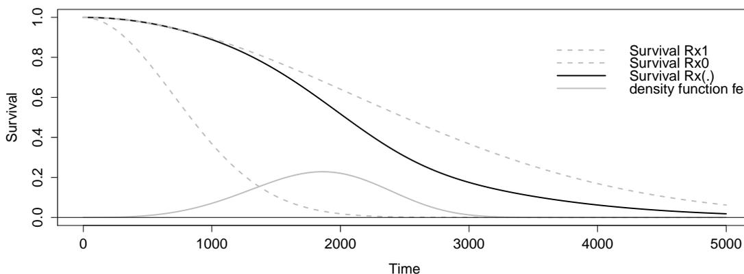
FIGURE 3 – Principe de dommage cumulé sous un stress en escalier à un saut aléatoire avec retour au stress initial après  $\Delta I$
