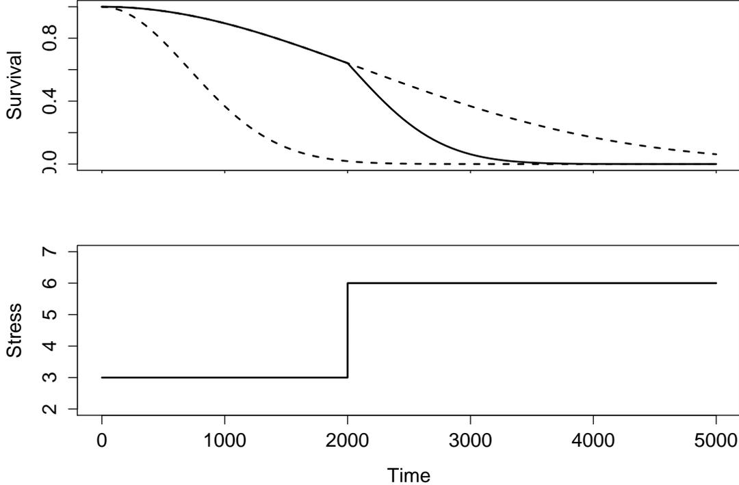
FIGURE 1 – Illustration du principe de dommage cumulé, fonction de survie sous un stress en escalier à un saut connu.
